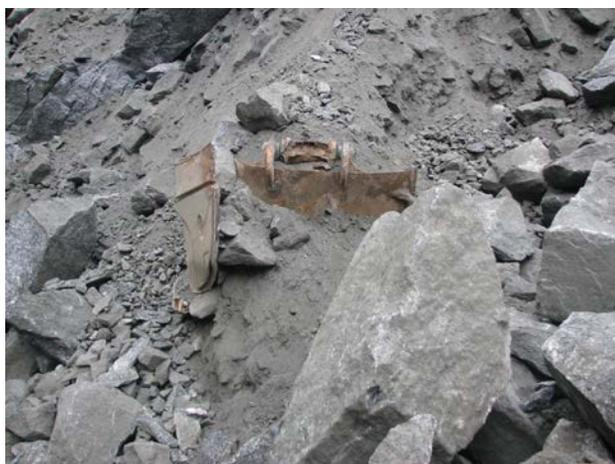
Foto 3. Detalhe do maquinário soterrado identificado pela magnetometria.
